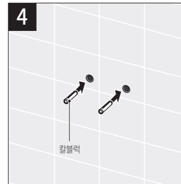
1차 천공한 위치에 드릴(Φ7~8)로 2차 천공합니다.(천공 깊이 약 35~45mm) 천공한 후 칼블럭을 망치를 이용하여 삽입합니다.
